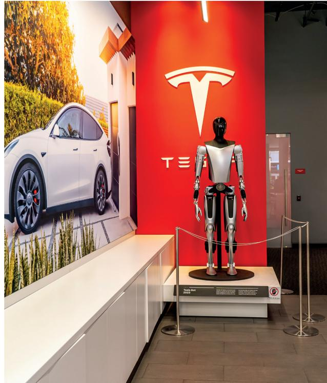
*Ces robots mesureront 1 mètre 72 et pèseront 56 kilogrammes. Ils auront la possibilité de se déplacer à une vitesse de 8 km/h, de transporter des charges de plus de 20 kg et peuvent soulever à la manière d'un haltérophile, une charge de 75 kg.*
